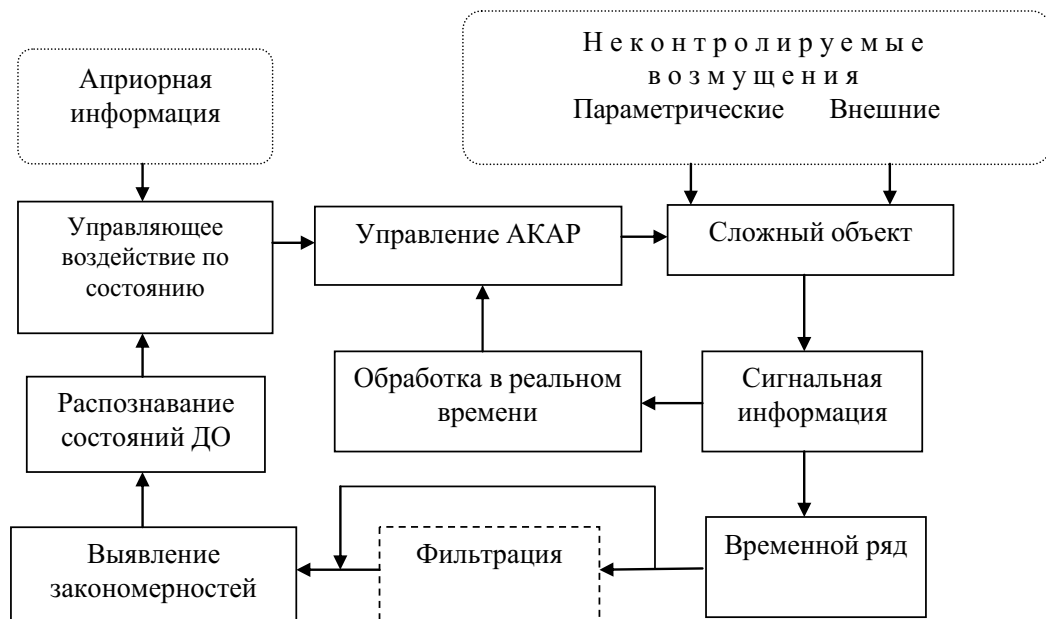
Рис. 7.1. Структурная схема совмещения традиционного управления по АКАР с адаптацией по состоянию для сложных ДО с неопределенностью
